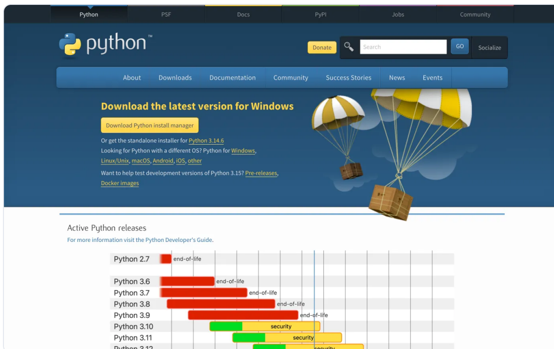
図3：Python のダウンロードページ。黄色いボタンではなく「Or get the standalone installer for」の青いリンクを使います
